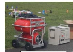
小型移動式 排水設備
