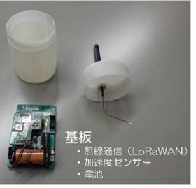
越水・決壊検知センサー（試験用）
