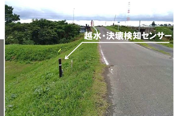
越水・決壊検知センサー
