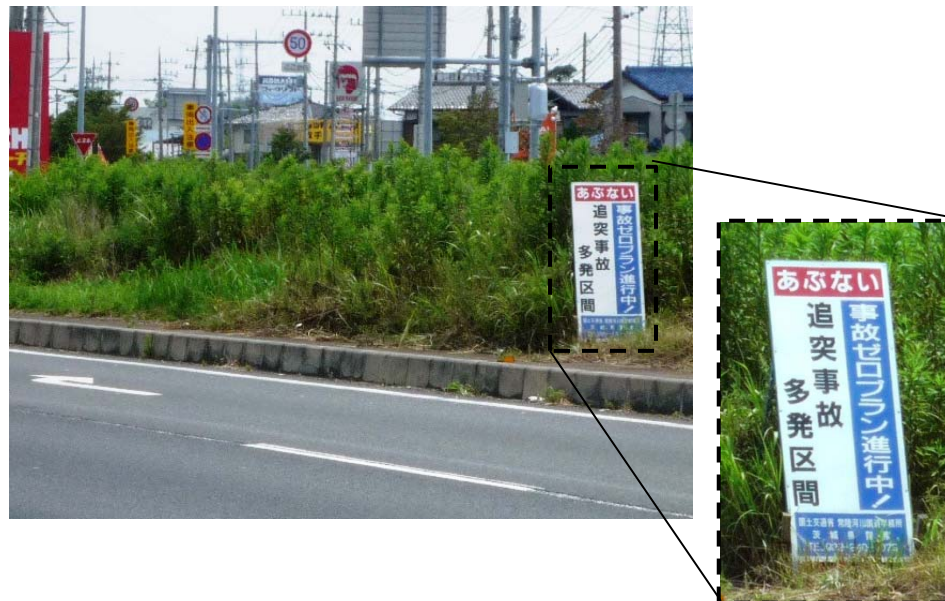
国道6号小浮気交差点における設置例 （追突事故多発区間の明示）
