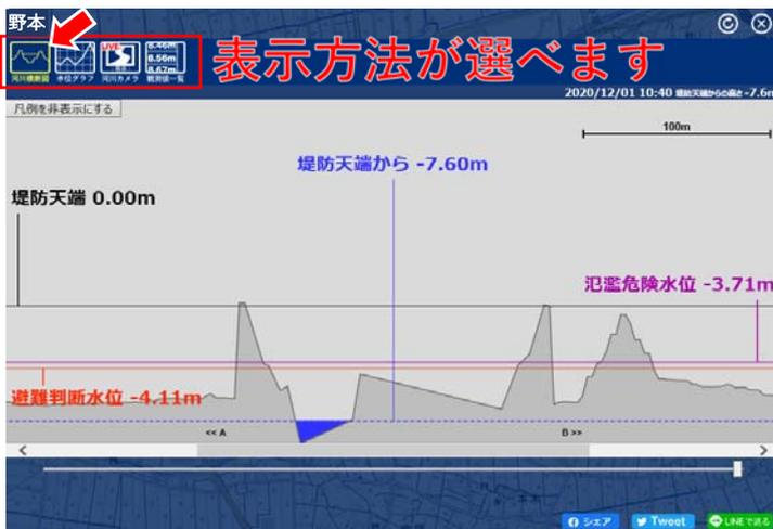
「河川横断図」では観測地点の川の断面と現在の水位（堤防天端からの差）を確認できます
