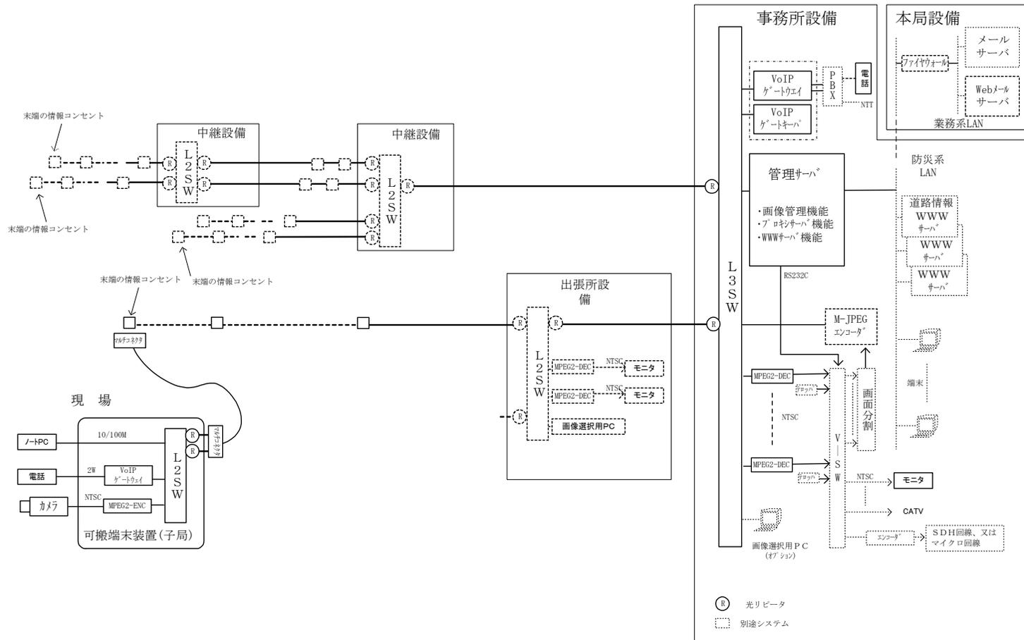
図4-3-1 情報コンセント設備の総合点検系統図（例）
