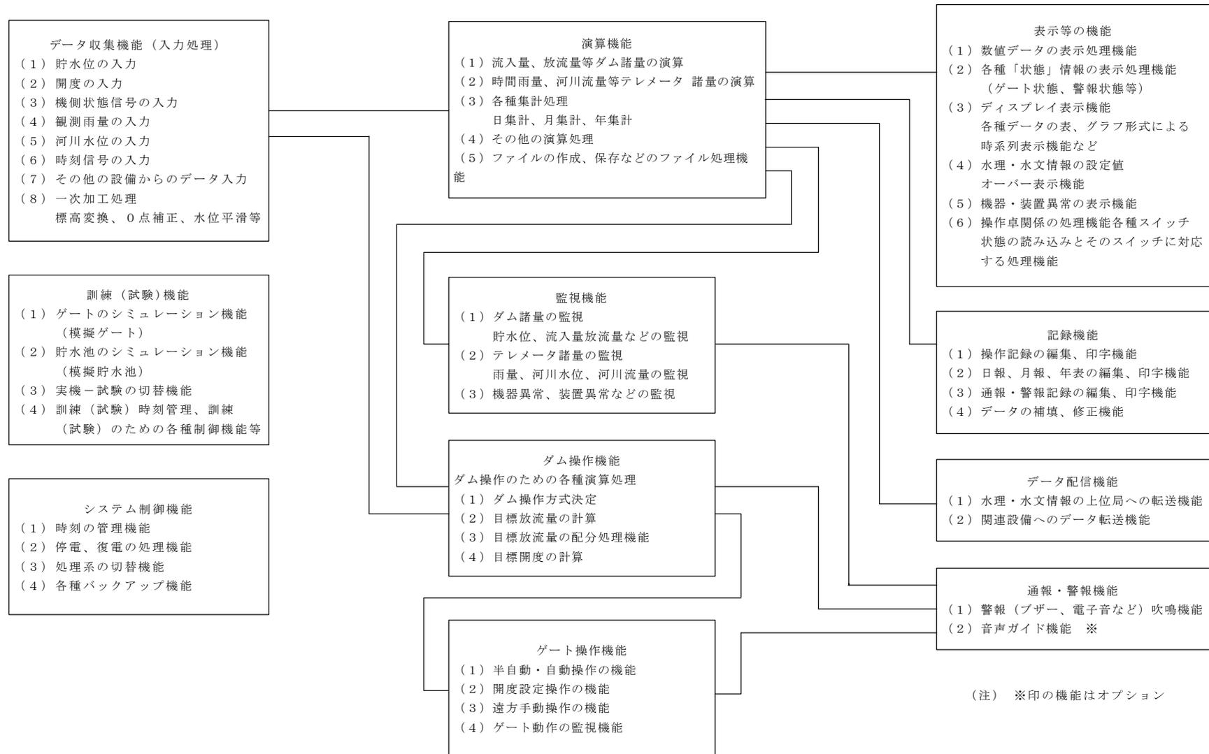
図1-3(2) ダム情報処理装置の機能構成 (システムレベルB~D)
