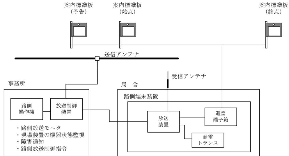
路側通信設備総合点検系統図 (例)
