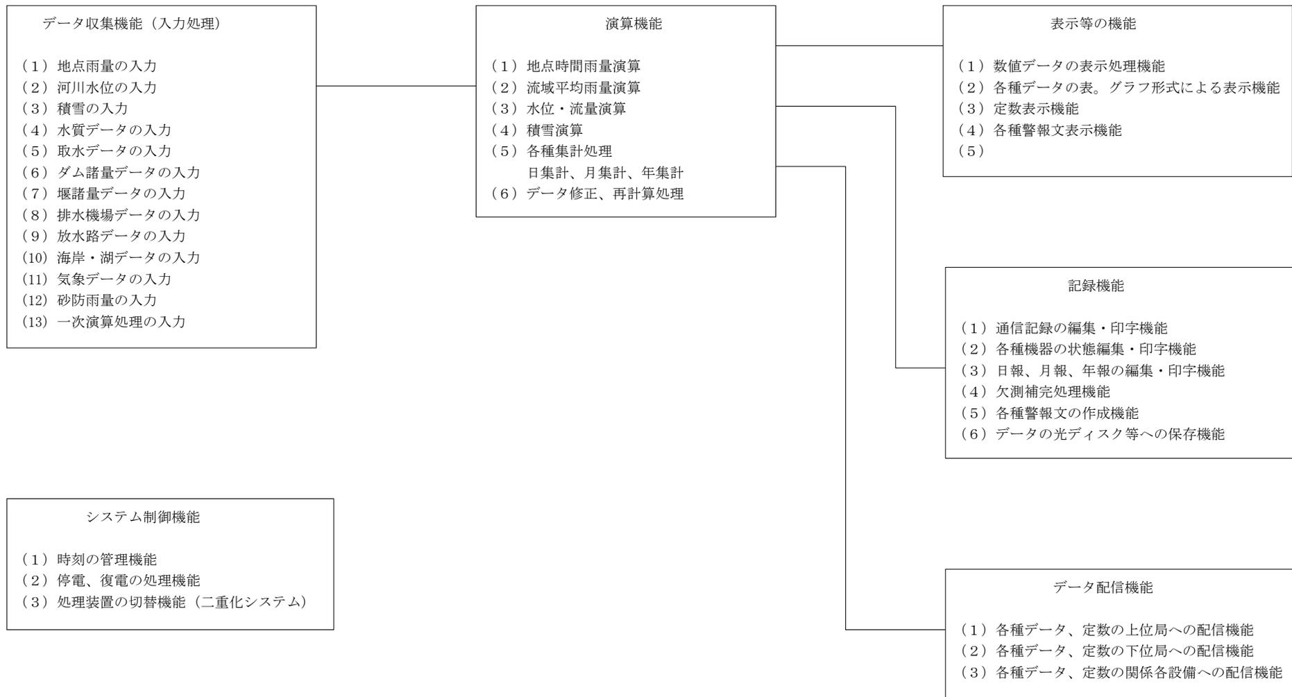
図 16-1-3 河川情報システムの機能構成
