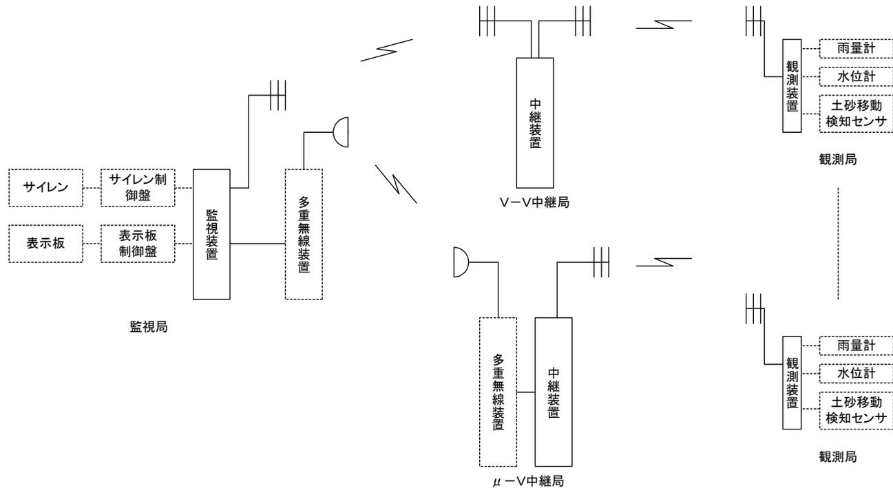
テレメータ装置（災害対策タイプ1）総合点検系統図（例）
