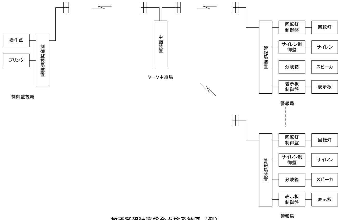
放流警報装置総合点検系統図（例）
