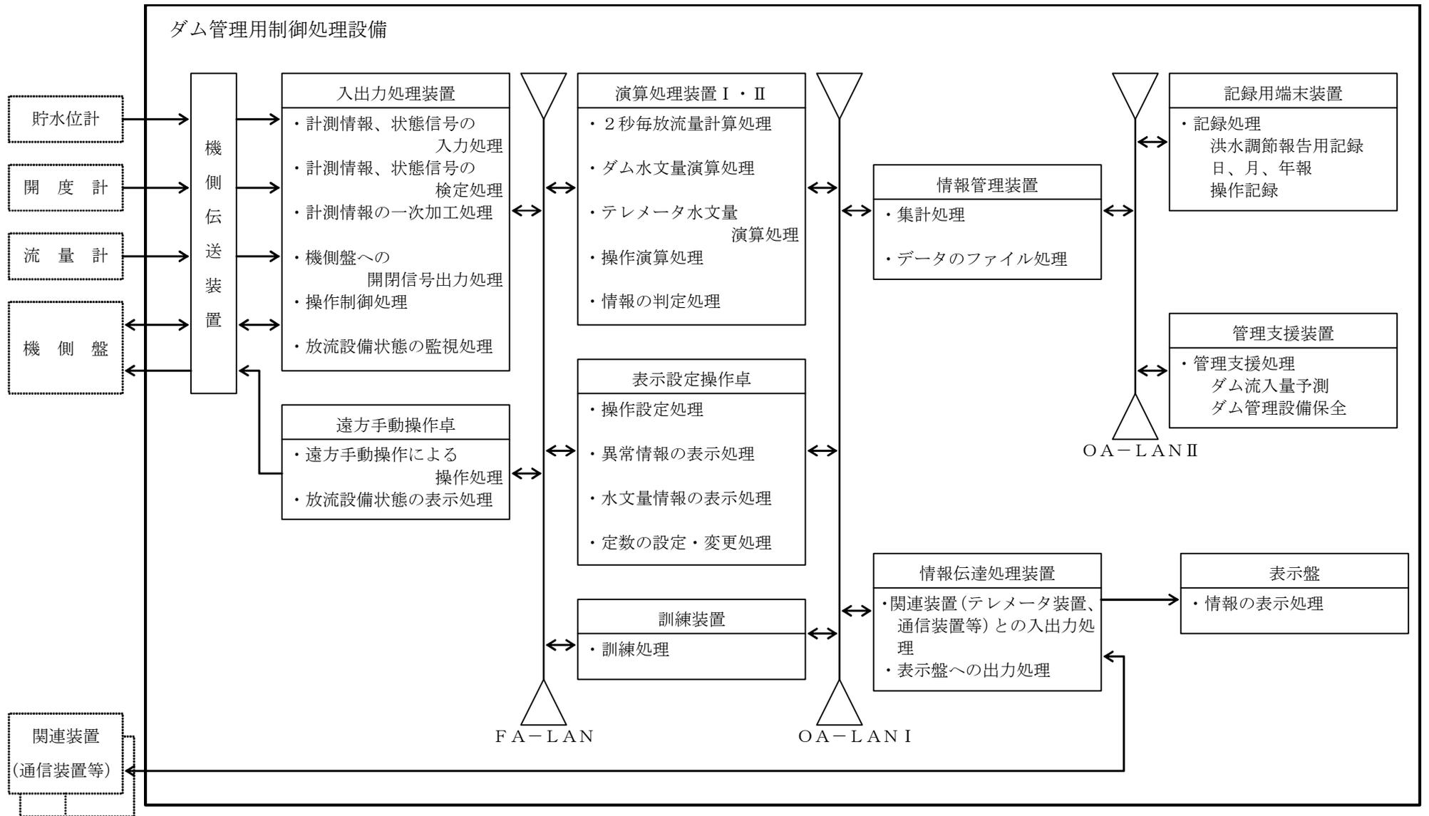
図2-3 ダム管理用制御処理設備と関連設備
