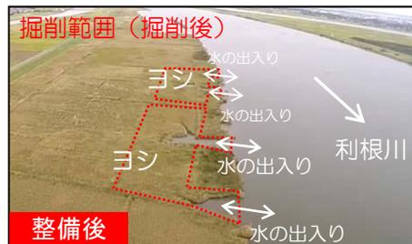
河川敷の水際を掘削しヨシを形成することで利根川の水が出入りし、水際部の水質浄化に寄与しています。
