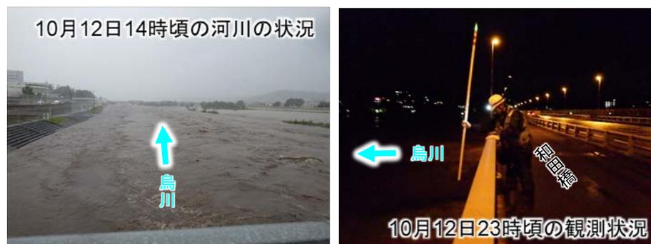
現状の流量観測は、河川の表面流速を計測し、その断面積から流量を算出しています。特に、洪水時の流速の計測については、多くの人員が必要であり、かつ、悪天候の中、橋の上から浮子を投入するという危険な作業を伴っています。
