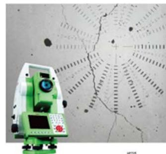
現在の技術(ひび割れ計測システム)
