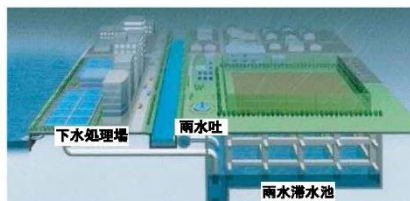
汚濁した初期雨水の滞り溜り池での貯留
