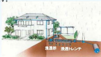
雨水浸透枳・トレンチの設置
