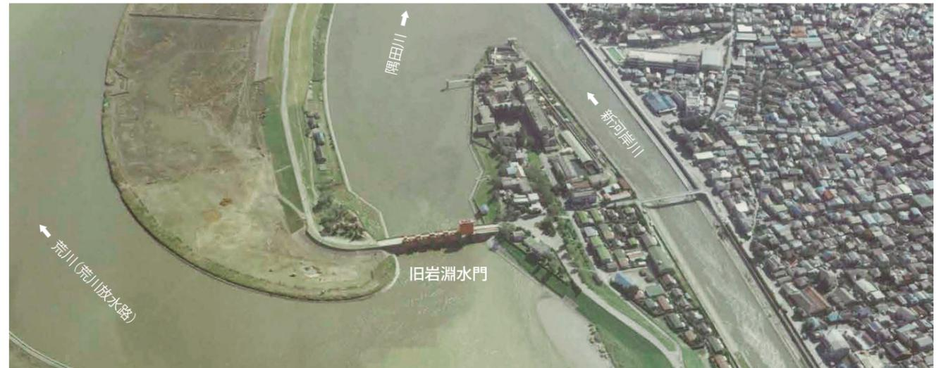
1924年(大正13)に完成した旧岩淵水門は、荒川放水路事業として築造された水門・閘門の中では、現存する唯一の構造物です。旧岩淵水門は、当時としては珍しい鉄筋コンクリート構造物で、以後築造された水門の手本となる先駆的なコンクリート河川構造物でした。
