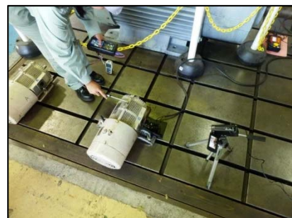
温度計測状況
