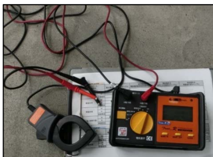
漏洩電流計測器 (関東技術保有 機器A)
