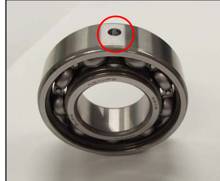
写真-22 電動機軸受への不具合(損傷)状況
