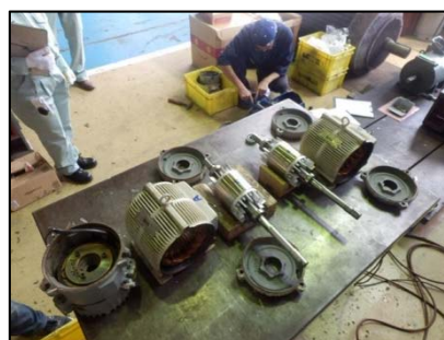
電動機分解（内部確認）
