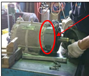
写真-24 電磁ブレーキをかける(過負荷)ための調整作業
