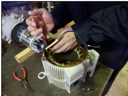
切断するケーブルの取出し
