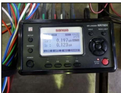
漏洩電流計測器 (位相補正機能有り 機器B)
