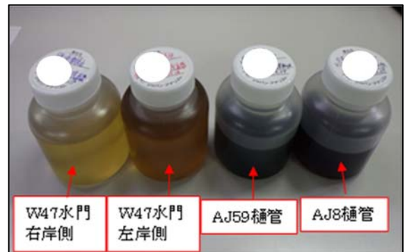
写真-13 フェログラフィ用に採油した潤滑油
