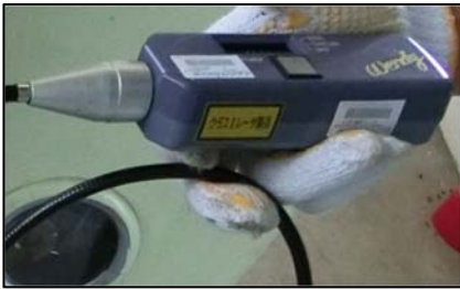
写真-10 簡易潤滑油診断器
