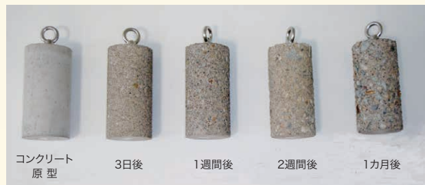
酸性の湯川の水につけた コンクリートの状態
