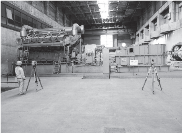
写真一 高精度3次元レーザスキャナを用いた床版変状計測技術（新技術情報提供システムより）
