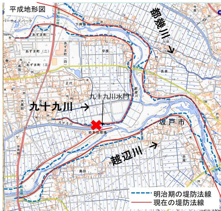
図 3. 2. 5 越辺川（九十九川）左岸 7. 6k 付近の堤防の変遷
