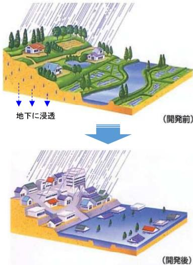
宅地造成等によって、雨水が地下に浸透せず、河川等に一度に流出して浸水被害をもたらす
