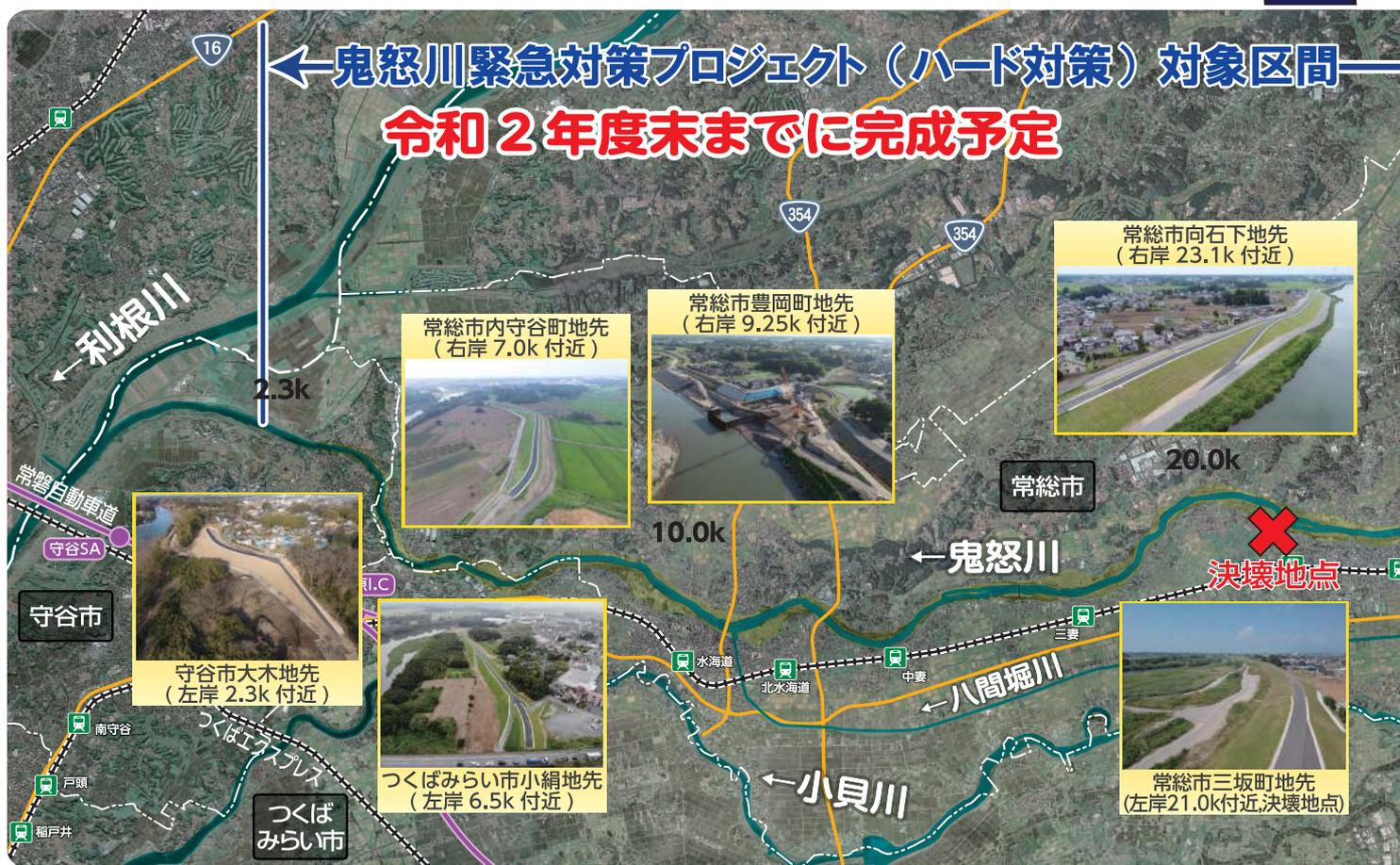
**堤防整備** 堤防が整備されていない区間の堤防整備や、高さや幅が不足している区間の堤防の高上げや拡幅等を行います。
