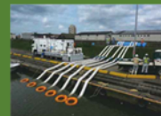
排水ポンプ車による排水状況
