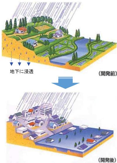
河川への流出抑制対策の例
