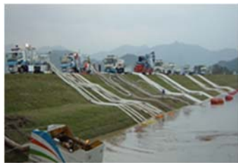
排水ポンプ車による緊急排水
