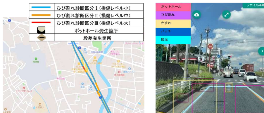
〈破損状況と評価から抽出した補修箇所のイメージ〉
