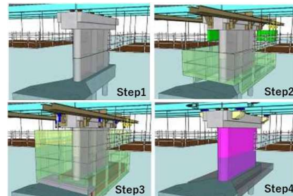
〈4D 施工シミュレーション〉
