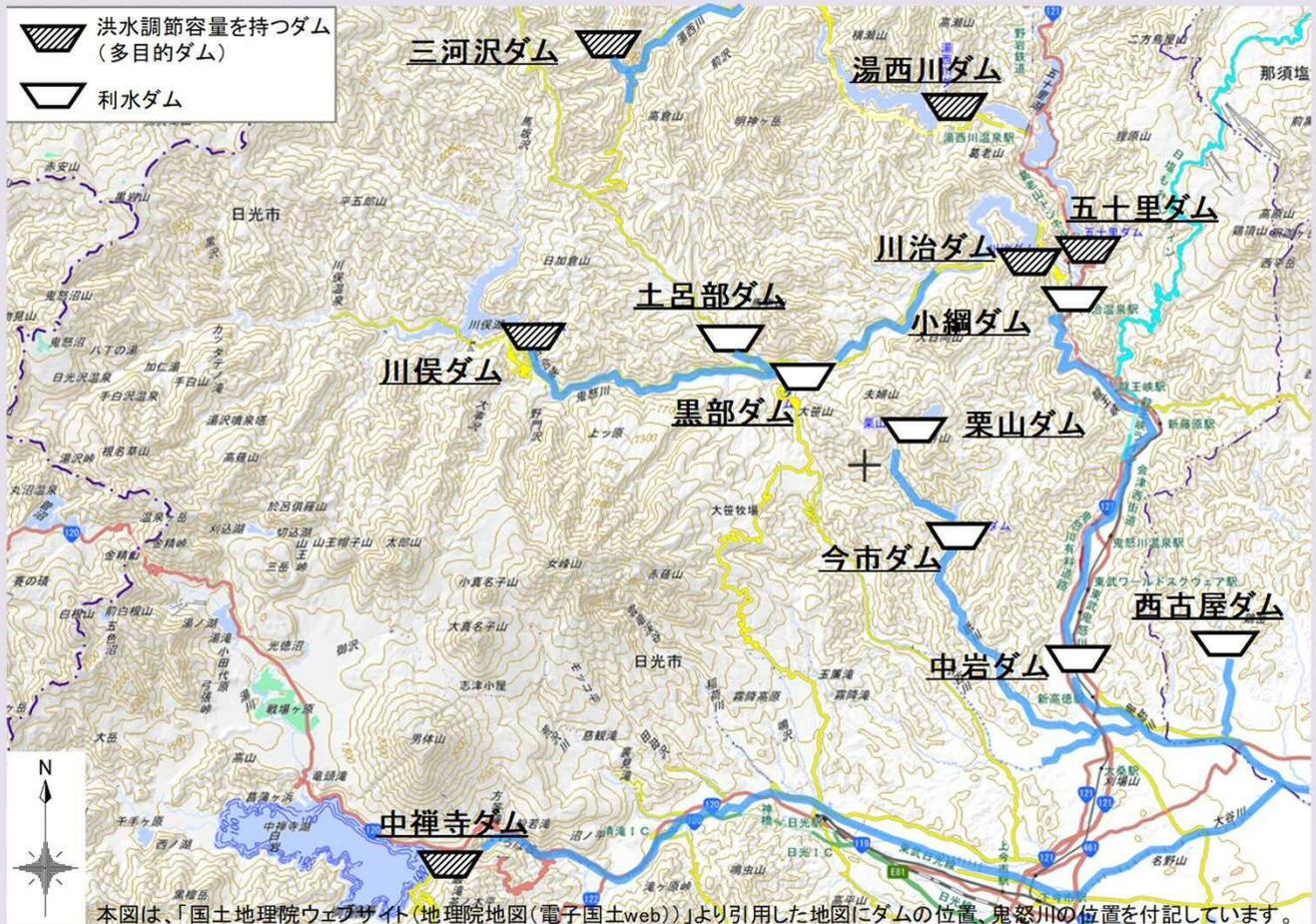
事前放流の実施により鬼怒川で洪水調節に利用するダム容量は、現況6ダム合計1.4億 $m^3$ から、最大時には13ダム合計2.8億 $m^3$ へと2倍に増強されます。
