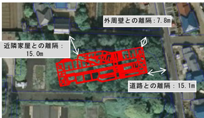
図-12 疑似堤防と周辺構造物の離隔
