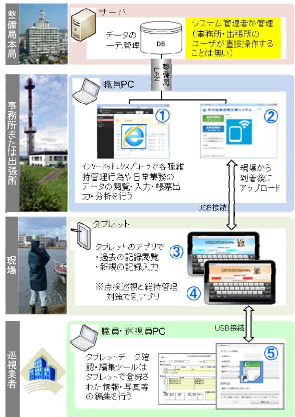
図-4 RMDISを構成しているシステムとデータの同期方法
