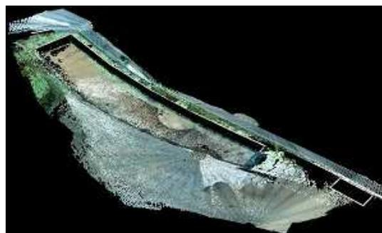
3Dレーザースキャナーにより取得した点群データ
