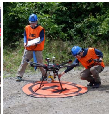
（写真左）堤防部における地質調査 （写真右）UAVを用いた河川測量
