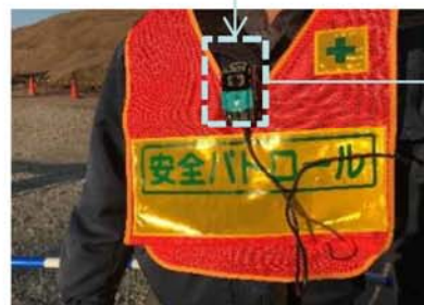
Webカメラを活用した 遠隔による現場確認
