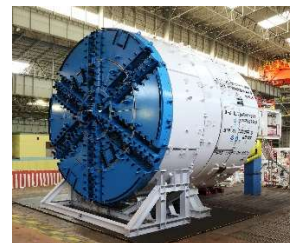
写真-2 シールドマシン全景
