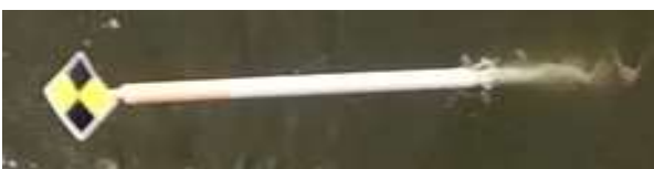
写真6 改良した浮子標識
