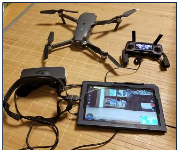
写真-1 事務所導入の汎用機体(DJI MAVIC2)の例
