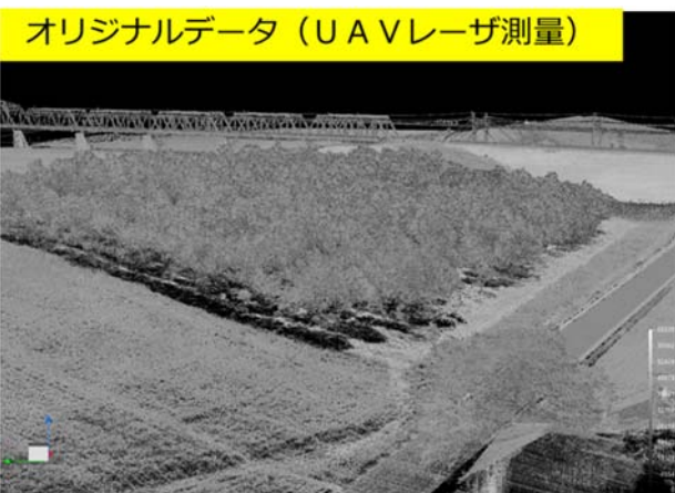
図-13 オリジナルデータ (UAV レーザ測量)
