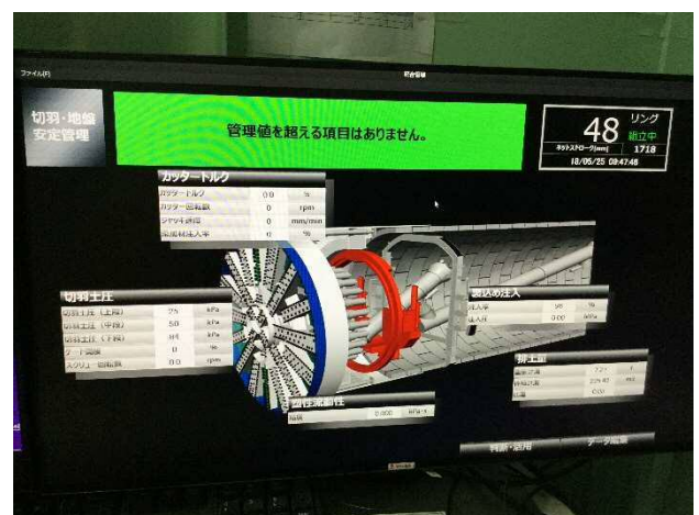
写真-2 シールド機運転席での一元管理
