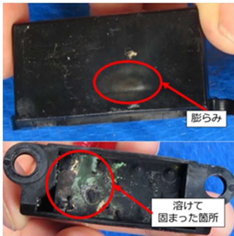
図5 破損した整流器
