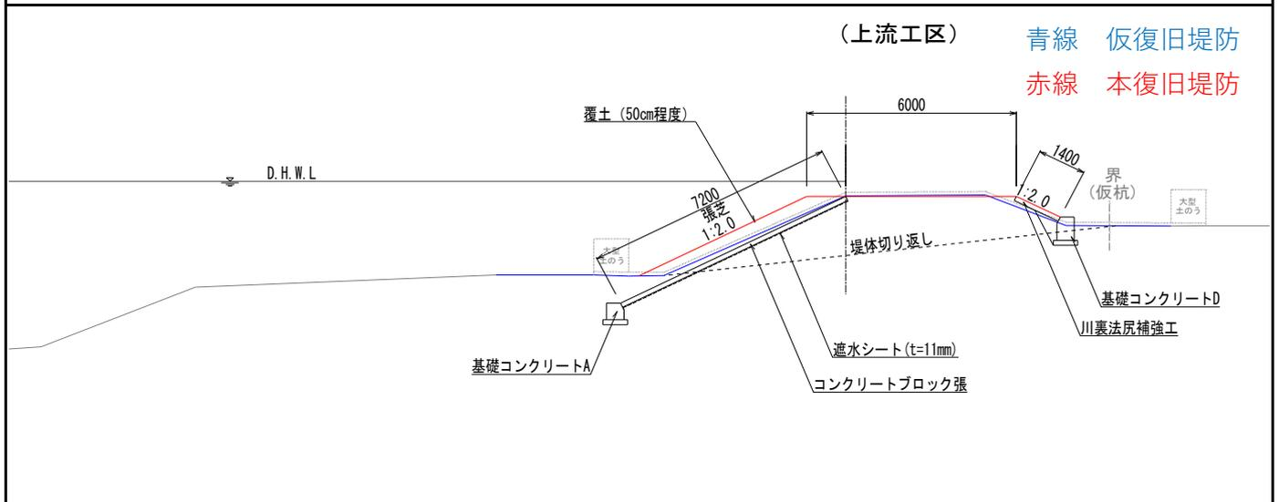
本工事は、台風19号の影響による決壊被害を受けた箇所を本復旧する工事です。堤防本体を拡幅し、川表側にコンクリートブロックを布設して覆土で補強し、川裏側に法尻対策としてブロックを敷設して補強する工事です。
