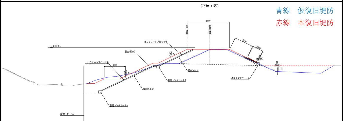
本工事は、台風19号の影響による決壊被害を受けた箇所を本復旧する工事です。堤防本体を拡幅し、川表側にコンクリートブロックを布設して覆土で補強し、川裏側に法尻対策としてブロックを敷設して補強する工事です。
