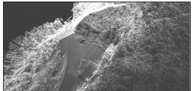
図-6 〈航空レーザ測量〉 斜め上空から広域の点群状況 本線から離れた箇所も多くの点群データが計測され、地形形状が確認できるが、詳細な地物は確認できない。
