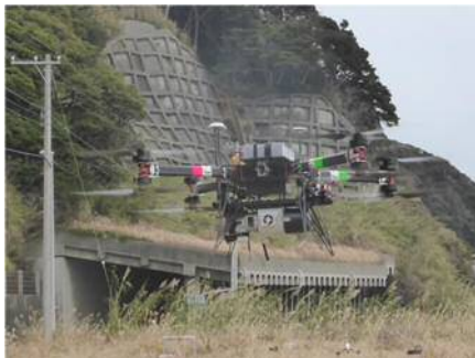
写真-2 UAVを用いたセンサ技術 （レーザスキャナ計測）
