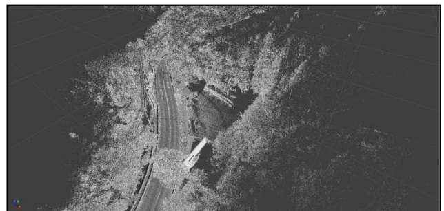
図-7 〈車載写真レーザ測量（MMS）〉 斜め上空からの点群状況
