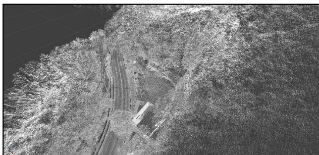
図-8 <航空レーザ測量と車載写真レーザ測量（MM S）の重ね合わせ> 本線から離れた箇所の地形形状も、道路周辺域の詳細な地物も把握可能である。
