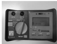
写真-7 漏洩電流測定器
