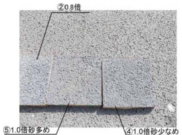
写真-4 現地舗装と供試体との比較状況
