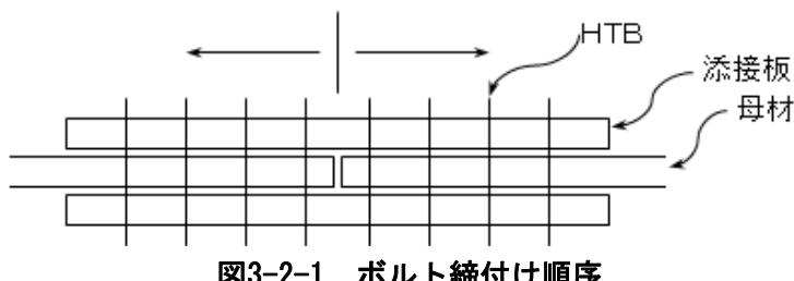
**図3-2-1 ボルト締付け順序**
