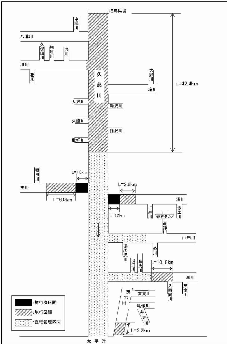
図・2.2 河川工事の施行区間模式図
