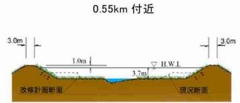
図・2.3 各河川の流量配分図及び代表断面図 (2)
