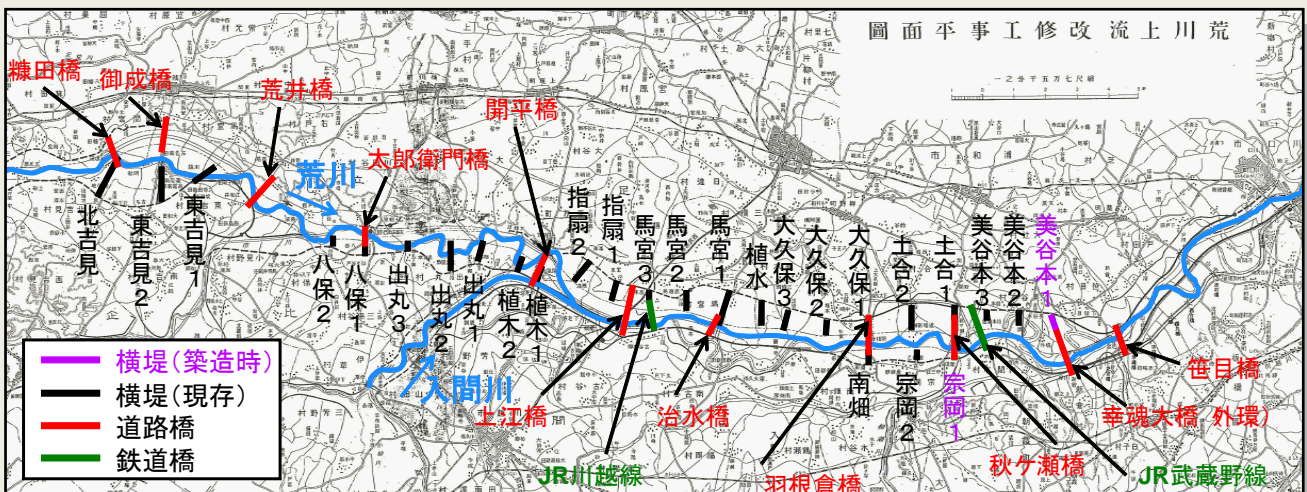
▲現在の荒川横堤と橋梁
