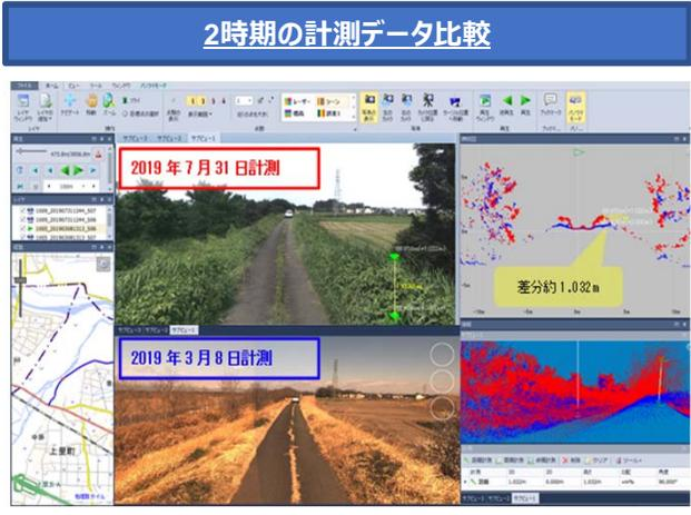
春季（3月）、夏季（7月）の2時期の計測データを比較し、植生の繁茂状況、草丈などを確認。MMSデータから堤防法面、高水敷の形状や、状況の把握を行う場合は、植生が繁茂していない時期の計測が有効。
