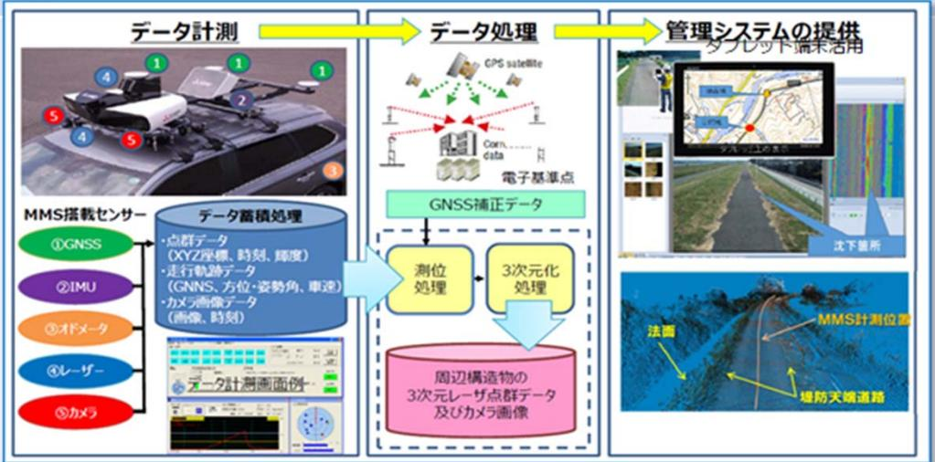
【新技術】パトロール車に搭載できるMMS取得装置及び管理システム
