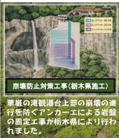
为了防止华严瀑布的上部塌陷，县内进行了锚固施工，并固定了基岩。
