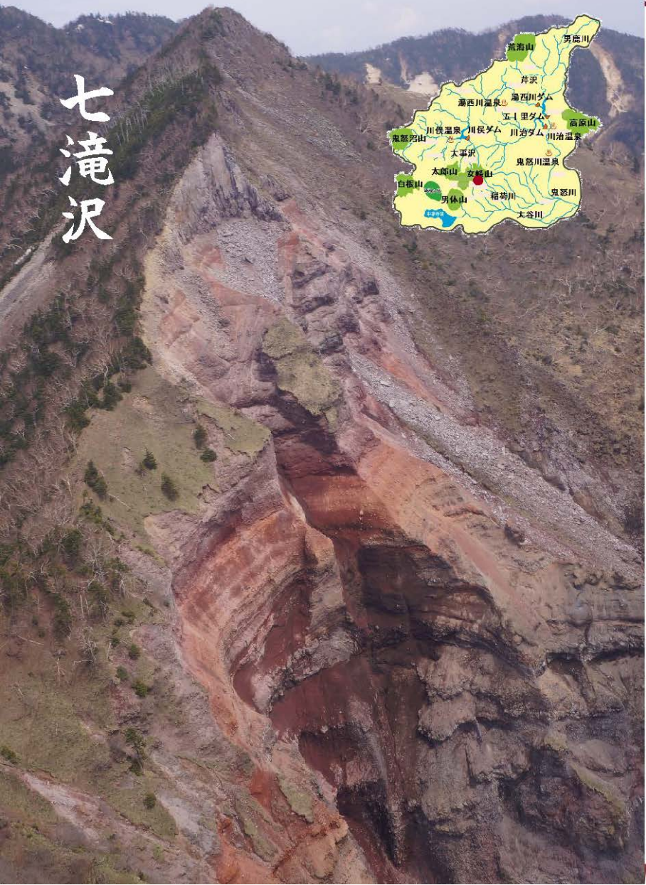
稻荷川上流七滝沢源頭部（女峰山の南）にある大規模崩壊地 で推定崩壊土砂量が180万 m^3 あります。
