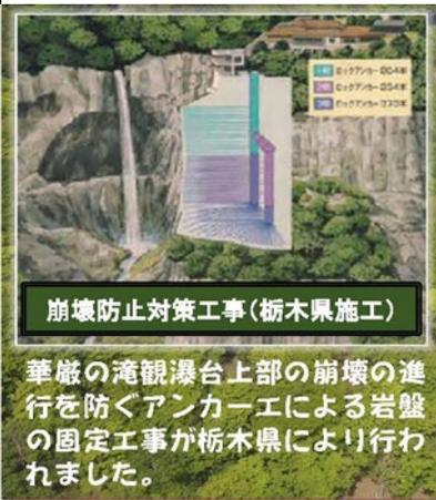
La construction de l'ancre a été réalisée par la préfecture pour éviter l'effondrement de la partie supérieure des chutes Kegon, et le socle a été fixé.
