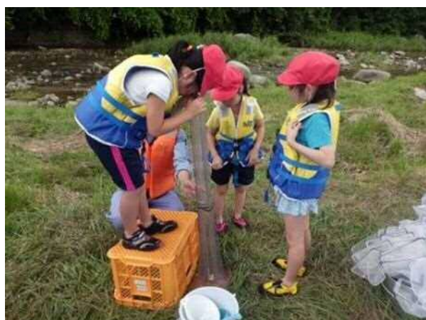
透視度計を使った水の濁りの計測
