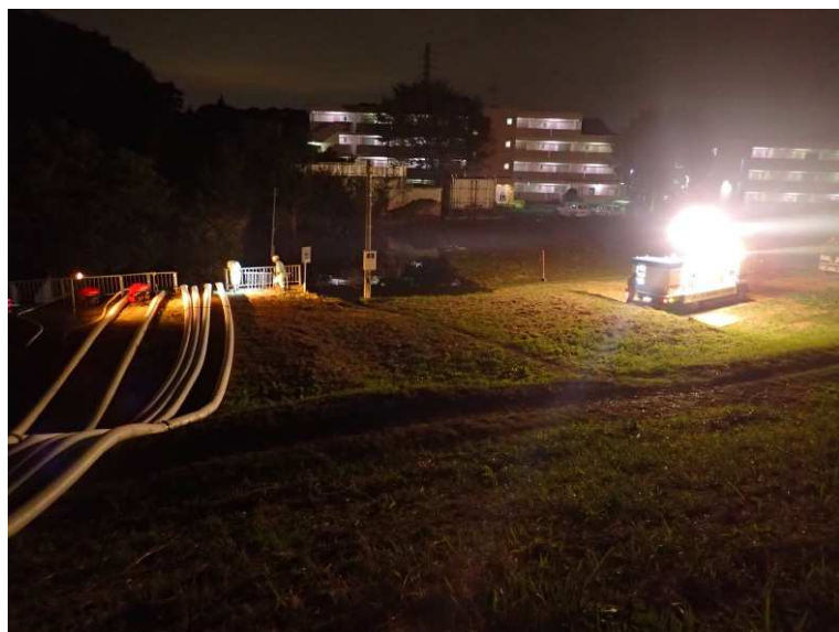
排水ポンプ車設置状況（諏訪下排水樋管 10月13日 20:00頃）
