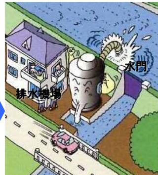
支川の氾濫を防ぐために排水ポンプで支川の水を汲み上げて本川に流す。
