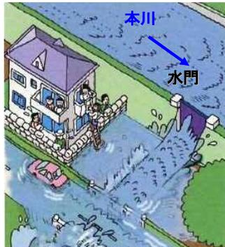
本川の堤防が支川の堤防より高い場合、本川の逆流を防ぐために水門・樋門を設置。
