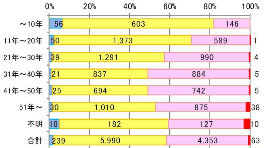
○ 判定区分と建設経過年数(トンネル)
