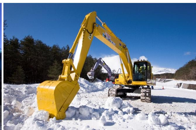
無人化施工による掘削試験
