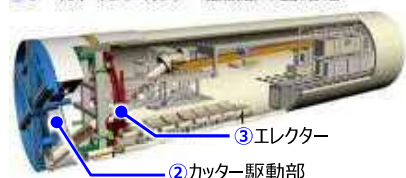
②シールドマシン カッター駆動部の密閉化
