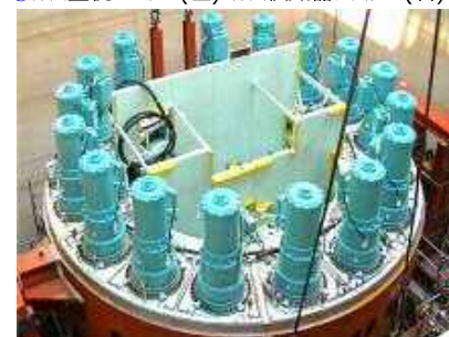
②シールドマシン カッター駆動部の密閉化
