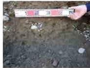
土質：細粒分混り砂質礫～粒径幅の広い砂質礫
