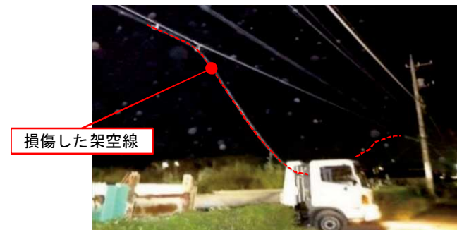
事故発生状況写真
